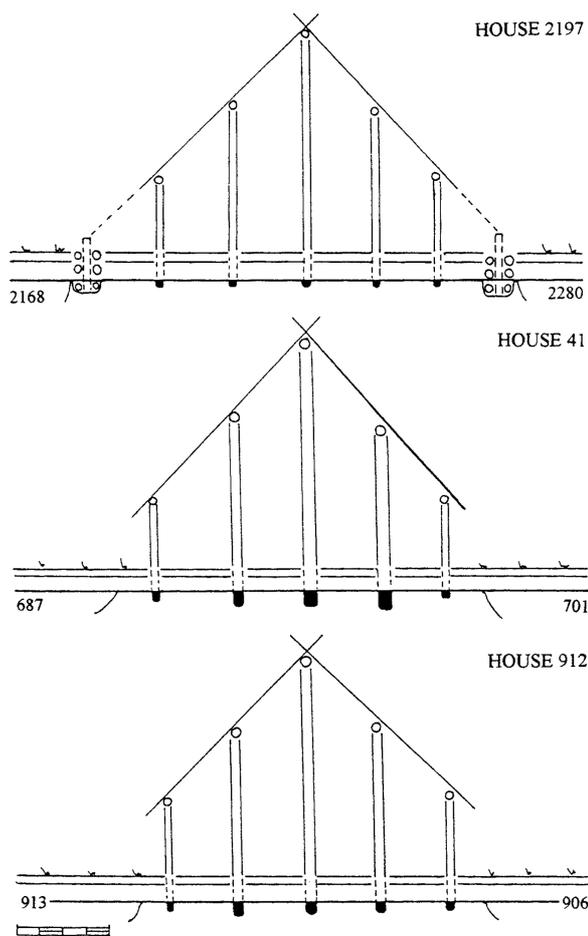
Fig. 6.2.1.a. Idealised reconstruction of an average cross-section through the structures of houses 41, 912 and 2197. - Ideální rekonstrukce průměrného příčného řezu stavba-mi domů 41, 912 a 2197.
