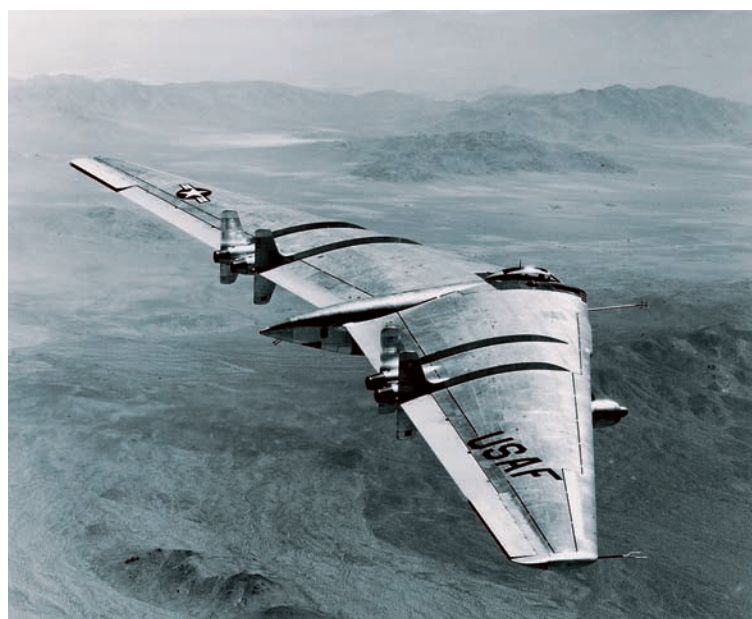
Ani vývoj moderních technologií se často neřídí pouze technickou logikou. Řada ve své době progresivních konstrukčních řešení letadel se neujala, protože se nepodobala letadlům, ve kterých byli piloti zvyklí létat. Příkladem je prototyp bombardéru Northrop YB-49, který vznikl krátce po druhé světové válce.
